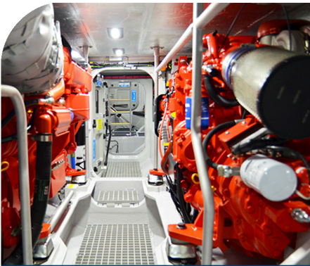
13-LITRE 650HP SCANIA D13 ENGINES
