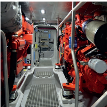
13-litre 650hp Scania D13 engines
